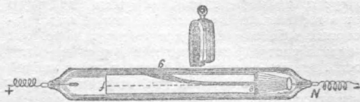
Отклонение магнитом пучка катодных лучей
